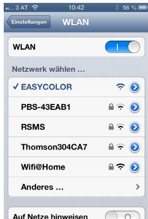
Schritt 8: Warten Sie bitte solange bis die Verbindung mit dem „EASYCOLOR PRO“ Netzwerk abgeschlossen ist. Sie benötigen dafür kein Passwort, da das Netzwerk ab Werk ungesichert ist. Dies kann später jedoch, auf Wunsch auch gesichert werden.
