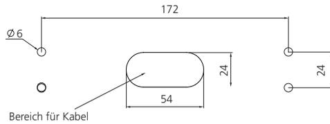
Bohrschablone für Deckenaufbauadapter.
