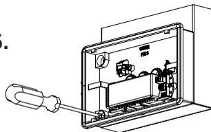
Elektronikgehäuse der Flexway an den Deckenadapter anschrauben.
