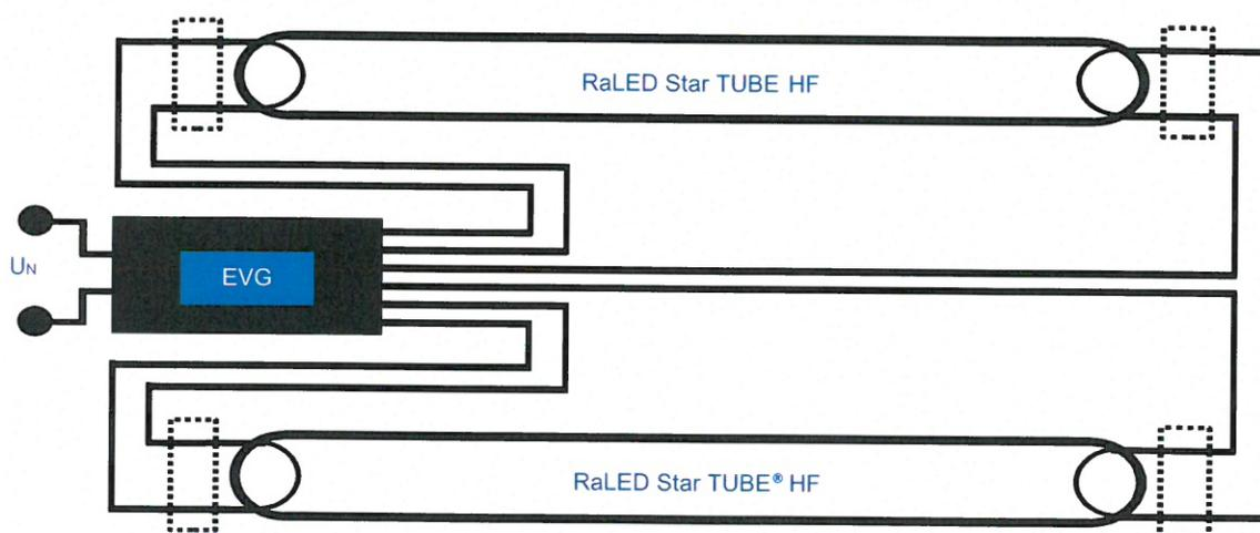
Auch bei mehrflammigen EVG-Leuchten wird die Verdrahtung nicht verändert. RaLED Star Tube HF muss kompatibel mit dem installierten EVG sein.
