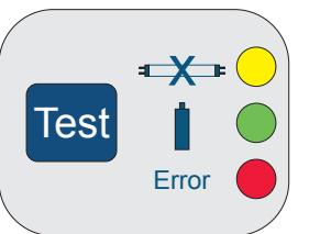
La module SelfControl est une unité de surveillance de quartz contrôlé pour les luminaires autonomes, qui exécute automatiquement des tests fonctionnels hebdomadaire et des tests annuels de durée.
