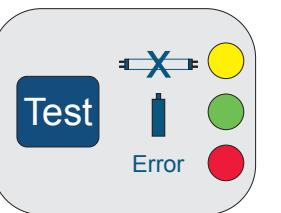
Das SelfControl Modul ist ein quarzgesteuerter Überwachungsbaustein für Einzelbatterieleuchten, welcher automatisch wöchentliche Funktionsprüfungen und jährliche Dauerprüfungen durchführt. Darüber hinaus besteht die Möglichkeit, diese Prüfungen auch manuell zu starten. Die Dauerprüfung kann für eine Bemessungsdauer von 1h, 3h und 8h eingestellt werden und deren automatische Auslösung kann deaktiviert werden.
