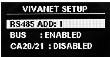
Schermata di modifica VIVANET SETUP pagina 1. E' possibile da questa pagina modificare l'indirizzo del dispositivo FREEmk3, FREENETmk3 e FREESOURCEmk3 sul bus RS485, attivare o disattivare il bus RS485. Utilizzare i tasti << e >> per spostarsi da un parametro all'altro. Utilizzare i tasti + e - per modificare il parametro selezionato. Una volta eseguite le modifiche confermare premendo il tasto ENTER.
