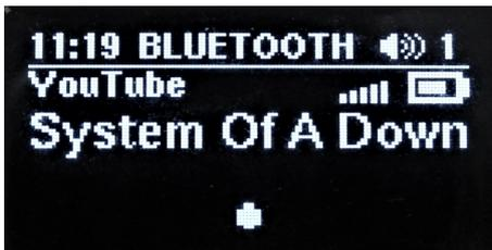
Questa schermata viene visualizzata quando un dispositivo Bluetooth è connesso a FREEmk3, FREENETmk3 e FREESOURCEmk3. Quando è attiva una trasmissione dati audio, comparirà il titolo della traccia e il nome dell'album in riproduzione, oltre ad una barra orizzontale in basso che indica il livello del segnale audio in ingresso. Se lo smartphone lo consente, verrà visualizzata anche l'intensità del segnale GSM
