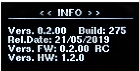
Schermata INFO numero 2. Viene riportata la versione del firmware installato sul dispositivo, la data di rilascio del firmware e la versione dell'hardware del dispositivo. Premere i tasti << e >> oppure i tasti + e - per visualizzare la schermata successiva.
