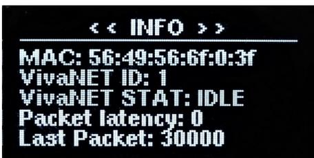
Schermata INFO numero 3. Viene riportato un indirizzo fisico per uso interno dei tecnici Vivaldi srl, l'indirizzo del dispositivo sul bus RS485, lo stato del bus RS485, IDLE se il bus è inattivo oppure ONLINE quando il bus è attivo, il tempo di attesa in ms dall'ultimo pacchetto dati ricevuto ed un contatore del tempo in accumulo in ms dall'ultimo pacchetto dati ricevuti. Premere i tasti << e >> oppure i tasti + e - per
