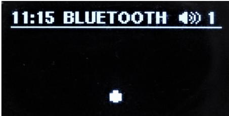
Schermata sorgente Bluetooth. FREEmk3, FREENETmk3 e FREESOURCEmk3 dispongono di un ricevitore Bluetooth 5.0 integrato, che permette tramite una connessione Bluetooth a corto raggio (max 8 mt in aria libera) con un dispositivo mobile come uno smartphone, di effettuare uno streaming audio verso quest' ultimi. Per far si che FREEmk3, FREENETmk3 e FREESOURCEmk3 vadano in pairing basterà premere il tasto
