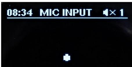
Schermata sorgente MIC INPUT. FREEmk3, FREENETmk3 e FREESOURCEmk3 dispongono della possibilità di usufruire dell'intercomunicazione microfonica tra due o più dispositivi connessi tra loro. La sorgente MIC INPUT nello specifico permette di ascoltare il segnale audio collegato all'ingresso MIC del dispositivo (vedi capitolo 4.2 voce 15). Attivando la sorgente MIC INPUT in un dispositivo FREEmk3,
