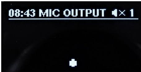
Schermata sorgente MIC OUTPUT. FREEmk3, FREENETmk3 e FREESOURCEmk3 dispongono della possibilità di usufruire dell'intercomunicazione microfonica tra due o più dispositivi connessi tra loro. La sorgente MIC OUTPUT nello specifico, permette di sfruttare la capsula microfonica frontale integrata su FREEmk3, FREENETmk3 e FREESOURCEmk3 (vedi capitolo 4.1 voce 2) per poter inviare
