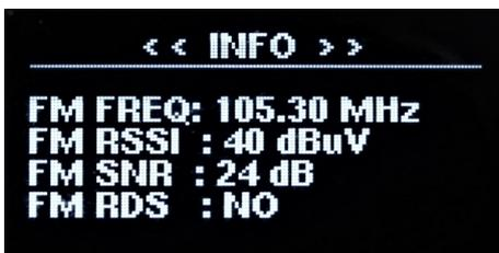
Schermata INFO numero 4. Se sul dispositivo FREEMmk3, FREENETmk3 e FREESOURCEmk3 è selezionata la sorgente RADIO FM o DAB+ e si va a visualizzare questa schermata, tramite il telecomando ad infrarosso TCIR5 in dotazione, è possibile con i tasti << e >> scorrere le varie frequenze FM/DAB+ e visualizzare quindi i valori sopra
