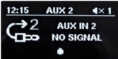
Schermata sorgente AUXIN 2. FREEmk3, FREENETmk3 e FREESOURCEmk3 dispongono di due ingressi audio di linea stereo a morsetto, denominati AUX1 e AUX2. All'ingresso AUX2 è possibile collegare una qualsiasi sorgente audio a livello linea (1 Vrms). Nel modello FREENETmk3 e FREESOURCEmk3, quando installato in abbinato alla matrice
