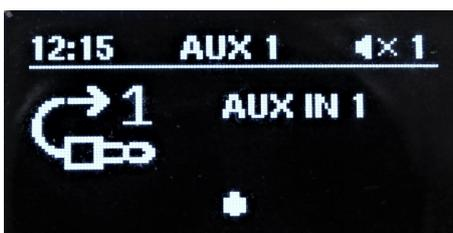
Schermata sorgente AUXIN 1. FREEmk3, FREENETmk3 e FREESOURCEmk3 dispongono di due ingressi audio di linea stereo a morsetto, denominati AUX1 e AUX2. All'ingresso AUX1 è possibile collegare una qualsiasi sorgente audio a livello linea (1 Vrms). Premendo brevemente il tasto ENTER si attiva e disattiva la funzione MUTO (simbolo X in alto a destra vicino al valore del volume). Premendo brevemente il tasto
