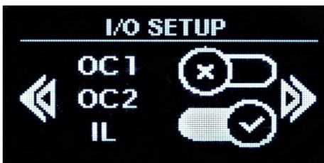
Schermata del menù ADVANCED SETUP che identifica la pagina I/O SETUP. FREEmk3, FREENETmk3 e FREESOURCEmk3 dispongono di tre pin a morsetto definiti OC1, OC2 e IL ,che sono degli open collector bidirezionali che permettono alcune funzioni tra i vari dispositivi collegati e il controllo degli accessori VIVALDI. Premere il tasto ENTER per
