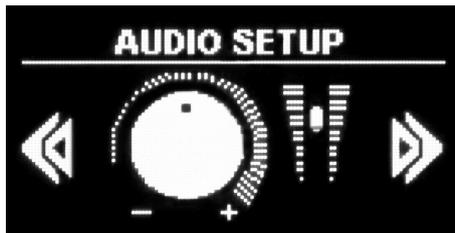
Schermata del menù ADVANCED SETUP che identifica la pagina dell'AUDIO SETUP. Da questa pagina è possibile configurare alcuni parametri di FREEmk3, FREENETmk3 e FREESOURCEmk3 riguardanti l'amplificatore (non presente nel FREESOURCEmk3), l'uscita AUX OUT ed il microfono. Premere il tasto ENTER per accedere alla schermata di modifica.
