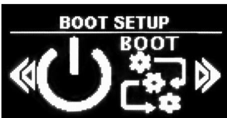
Schermata del menù ADVANCED SETUP che identifica la pagina del BOOT SETUP. Da questa pagina è possibile configurare alcuni parametri di FREEmk3, FREENETmk3 e FREESOURCEmk3 riguardanti la fase di avvio del dispositivo. Premere il tasto ENTER per accedere alla schermata di modifica.
