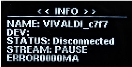
Schermata INFO numero 5. Viene riportato il nome del dispositivo Bluetooth, alternato al suo MAC address, il nome del dispositivo Bluetooth collegato, lo stato della connessione e lo stato dello streaming audio al dispositivo, se in play o pausa. Premere i tasti << e >> oppure i tasti + e - per visualizzare la schermata successiva.
