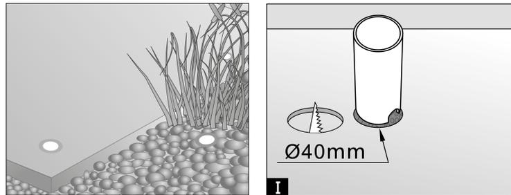
Bohren Sie an der gewünschten Stelle ein Loch, um die vertiefte Stelle mit einem Durchmesser von 40 mm oben zu installieren. Achten Sie also darauf, nicht zu viel oder zu wenig zu bohren.
