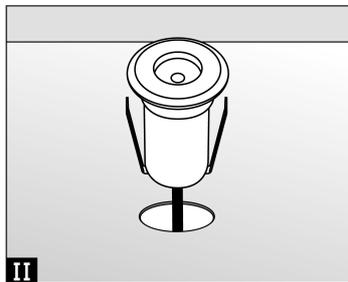
Führen Sie Ihren Punkt in den gebohrten Punkt ein und achten Sie darauf, dass die Verkabelung nicht eingeklemmt wird.
