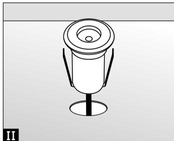
Inserisci il tuo spot nel punto perforato, facendo attenzione a non intrappolare il cablaggio.
