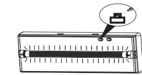
Test Butonu: Kapı açıldıktan sonra tornavida yardımı ile butona basılır. Pilin devreye geçip floresanı yaktığı görülr.
