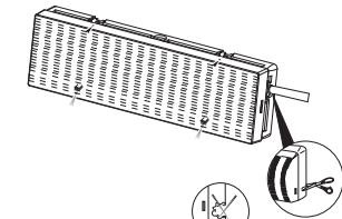
Armatür kablo bağlantısı için makas vb. malzemeler yardımıyla belli olmuş olan bölümü düzgünce kesiniz.
