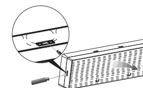
Floresan değişimi için armatürün yan kısmındaki tırmaklar yardımıyla ona kapak açılır.
