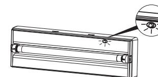
Yeşil Led: Cihaz beslemesi mevcut ve şarj işlemi sürüyor.
