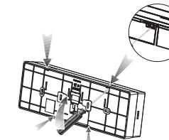
Arka kapağı çıkartmak için yanlarında bulunan tırmakları tornavida yardımı ile açınız.
