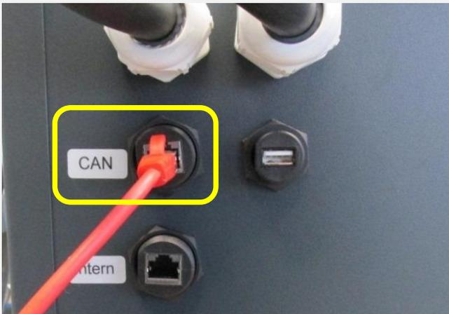
*Abbildung 4-6 Darstellung der externen Anschlüsse des Batteriesystems, CAN*
