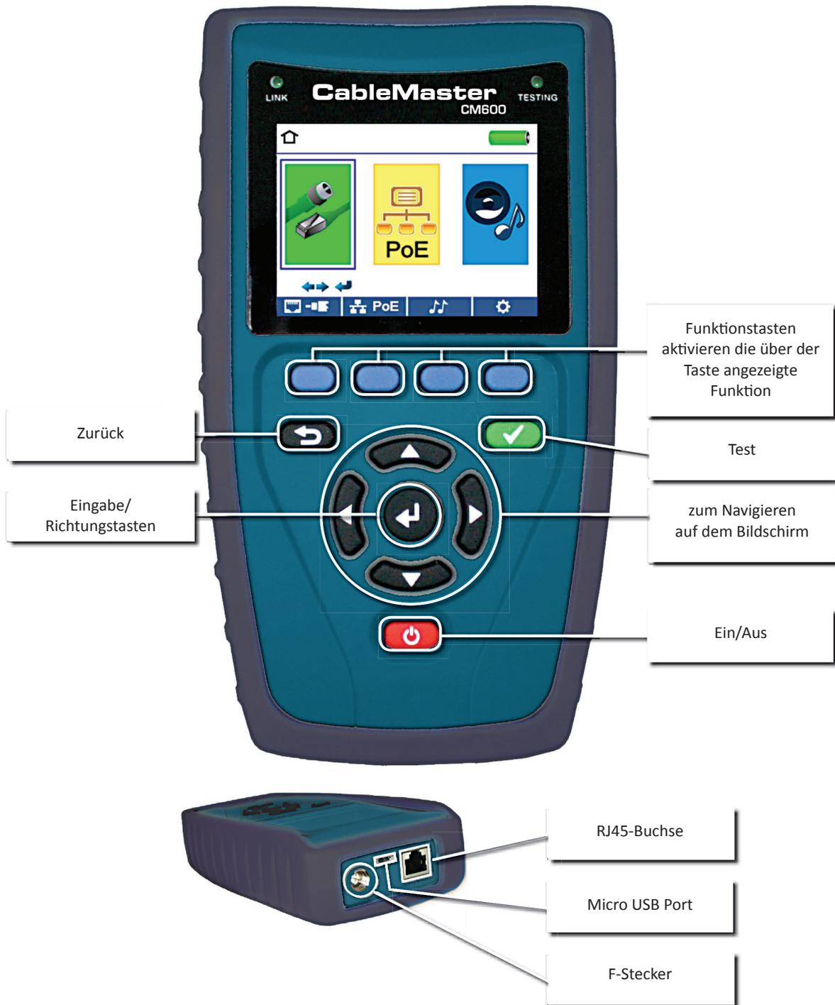
*(Warnung! Stecken Sie niemals ein RJ11-Kabel direkt in den CableMaster 800/850. Ein Standard RJ11-Kabel beschädigt die RJ45-Buchse des CableMaster 800. Verwenden Sie in diesem Fall das im Lieferumfang des CableMaster 800/850 enthaltene RJ-Testkabel.)*
