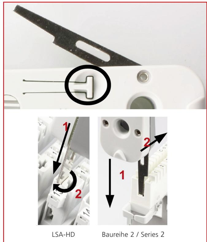
Entriegelungsklinge / Module removal blade
