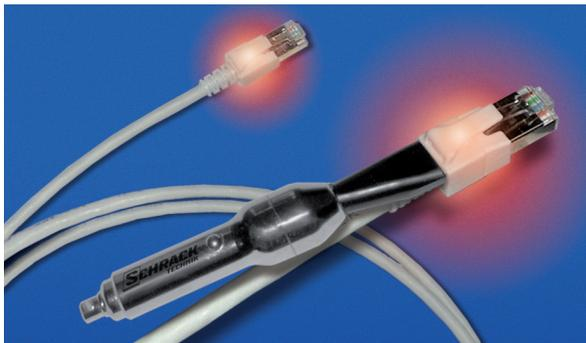
Durch Anstecken des Patchfinders an die Öffnungen werden beide Knickschutztüllen an den Enden zum rot Leuchten gebracht. Die Datenübertragung bleibt dabei selbstverständlich gewährleistet. Zur optimalen Identifizierung stehen drei Betriebsmodi zur Verfügung: Dauerleuchten, langsam oder schnell blinkend. Dadurch ist die Zuordnung auch im komplexen Blinklicht von Switchports garantiert.
