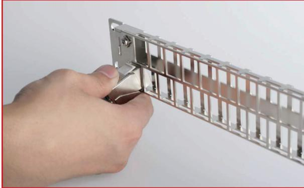
Setzen Sie die Keystone Buchse in die untere Reihe ein. Der Halte-Clip zeigt nach oben. /
