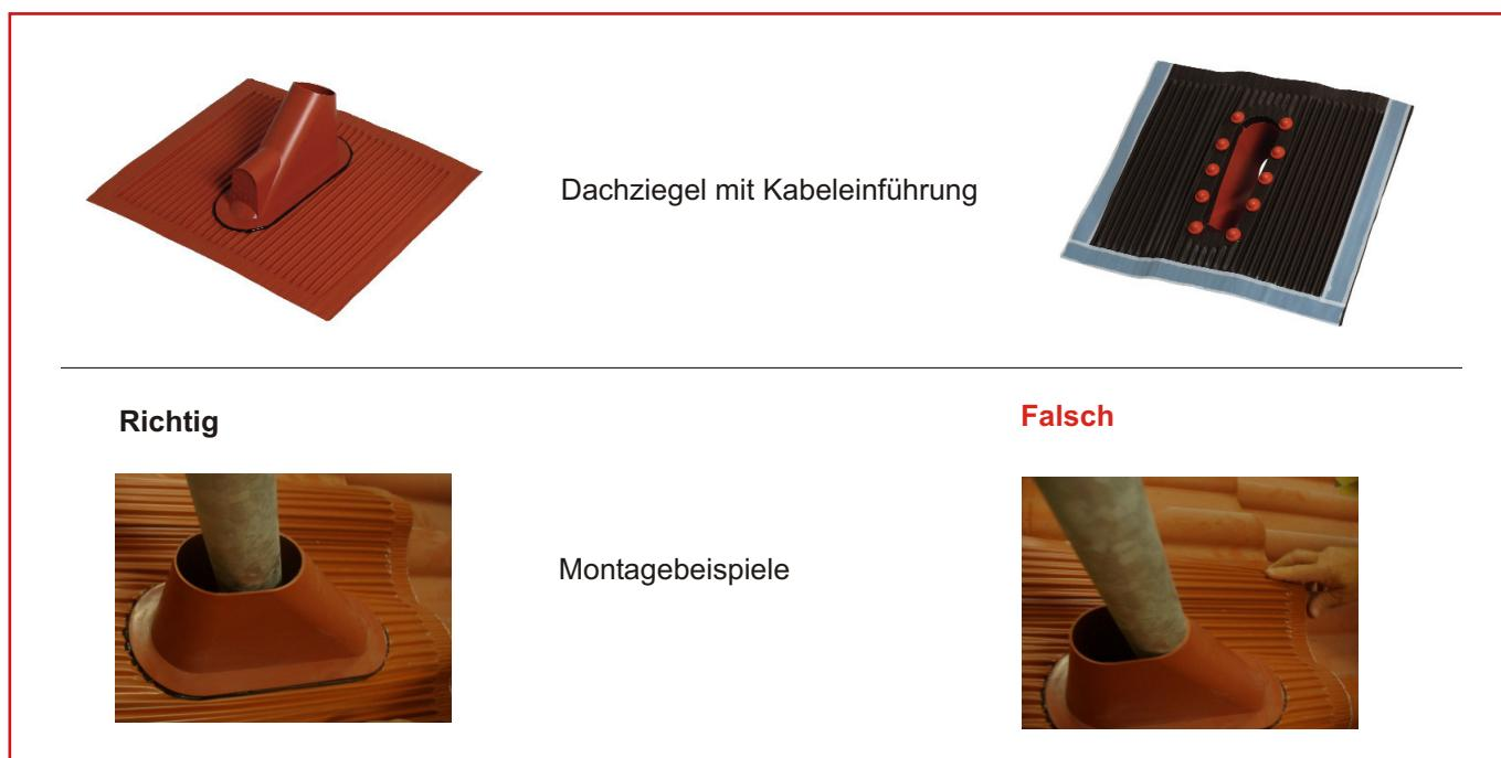
Achten Sie unbedingt darauf, dass der Aluziegel und das Mastrohr zueinander mittig ausgerichtet sind und das Mastrohr den Ziegel an keiner Stelle berührt. Es darf weder Druck noch Spannung auf den Ziegel wirken. Der Aluminiumziegel ist durch Butylklebestreifen fest mit dem Dach verbunden. Durch die mittige Ausrichtung erhält der Mast den notwendigen Spielraum zum „schwingen“. Wird ihm dieser Spielraum nicht gewährt, kann der Ziegel mit der Zeit beschädigt werden.
