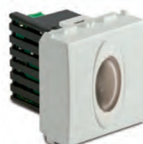
36466.2 Segnalatore d'emergenza 2 moduli, autonomia 12h, luminosità 3cd, alimentazione 230V~, bianco
