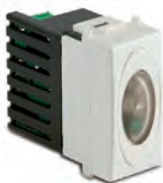
36465 Lampada d'emergenza 1 modulo, autonomia 120', luminosità 16cd, alimentazione 230V~, bianco
