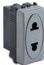
33185 Preso 2P 16A 250V~ Euroamericana, fori Ø 4,8 mm, Steel
