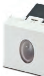
21466.2 Segnalatore d'emergenza 2 moduli, autonomia 12h, luminosità 3cd, alimentazione 230V~
