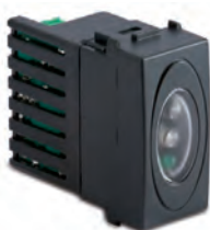
31465 Lampada d'emergenza 1 modulo, autonomia 120', luminosità 16cd, alimentazione 230V~, grigio
