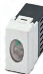
21465 Lampada d'emergenza 1 modulo, autonomia 120', luminosità 16cd, alimentazione 230V~
