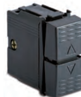
31027 Commutatore 2P 16AX (6 Morsetti) 16AX 250V~, grigio
