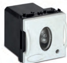
36462 Lampada d'emergenza estraibile 2 moduli, autonomia 120', luminosità 16cd, alimentazione 230V con interruttore, bianco
