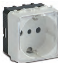
36174 Presse UNEL P30 2P+T laterale e centrale 16A con portello IP40, bianco
