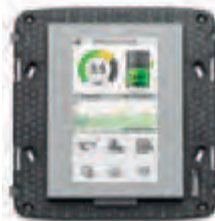
21511.BN 4,3" Full Flat pentru control și comandă, intrare pentru senzor de temperatură, cu suport pentru instalare în casete cu 8 module. Adâncime: 39,9 mm
