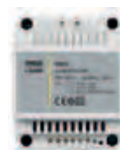
02032 Alimentator Due Fii pentru leduri şi camere video tip TVCC cu ieşiri 10,5 V d.c., 13,5 V d.c., 18 V d.c. 35 VA, alimentare 230 V~ 50-60 Hz
