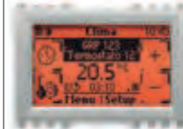
21509.N Pentru control și configurare, afișaj monocromatic, intrare pentru senzor de temperatură, pentru instalare pe bară DIN (60715 TH35) sau prin încorporare - 3 module. Adâncime: 37 mm
