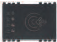
■ 19457 Cititor de carduri cu transponder, pentru instalare la exteriorul încăperii, standard KNX, - 2 ieșiri pe releu NO 4 A 24 V~, 2 intrări, 12-24 V~ 50/60 Hz și 12-24 Vdc (SELV) - 3 module. Furnizat fără card cu transponder
