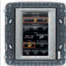
Δ 20848.1.N Ecran tactil color 4,3" pentru control și comandă, cu intrare senzor temperatură, cu suport pentru instalarea în casete 8 module. Adâncime: 39,9 mm
