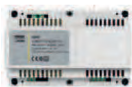
02030 Alimentator Due Fii cu ieşire 28 V d.c. 60 VA, alimentare 230 V~ 50-60 Hz
