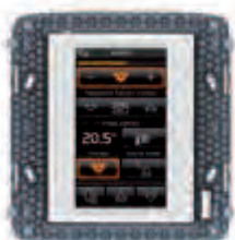
▲ 20511.1.B Ecran tactil color 4,3" Energy, pentru comandă, cu intrare senzor de temperatură, cu ramă încorporată 8 module. Adâncime: 25,5 mm
