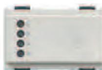
■ 16927.B Cititor de carduri cu transponder, pentru instalare la exteriorul încăperii, standard KNX, 2 ieșiri pe releu NO 4 A 24 V~, 2 intrări, 12-24 V~ 50-60 Hz și 12-24 V d.c. (SELV) - 3 module. Furnizat fără card cu transponder
