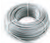
01840 Cablul pt. sistem Bus, 2x0,50 mm 2 , tensiune nominală spre pământ 400 V, adekvată pentru instalarea cu cabluri de Categoria I, alb - 100 m
