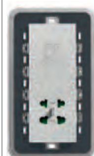
20291.N 6 230 V~ 50/60 Hz, cu 20 VA transf deizolare, iesire 230 V~ si 120 V~. Adâncime: 41 mm
