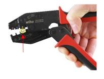
5.1 Werkzeug schließen, bis es selbständig öffnet.
