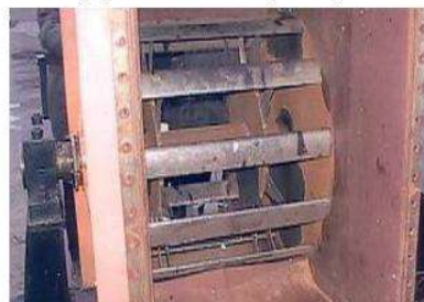
(d) Cross-flow turbine (Russia)
