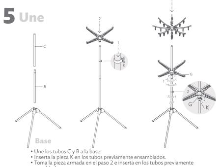
Toma la pieza armada en el paso 2 e inserta en los tubos previamento ensamblados.
