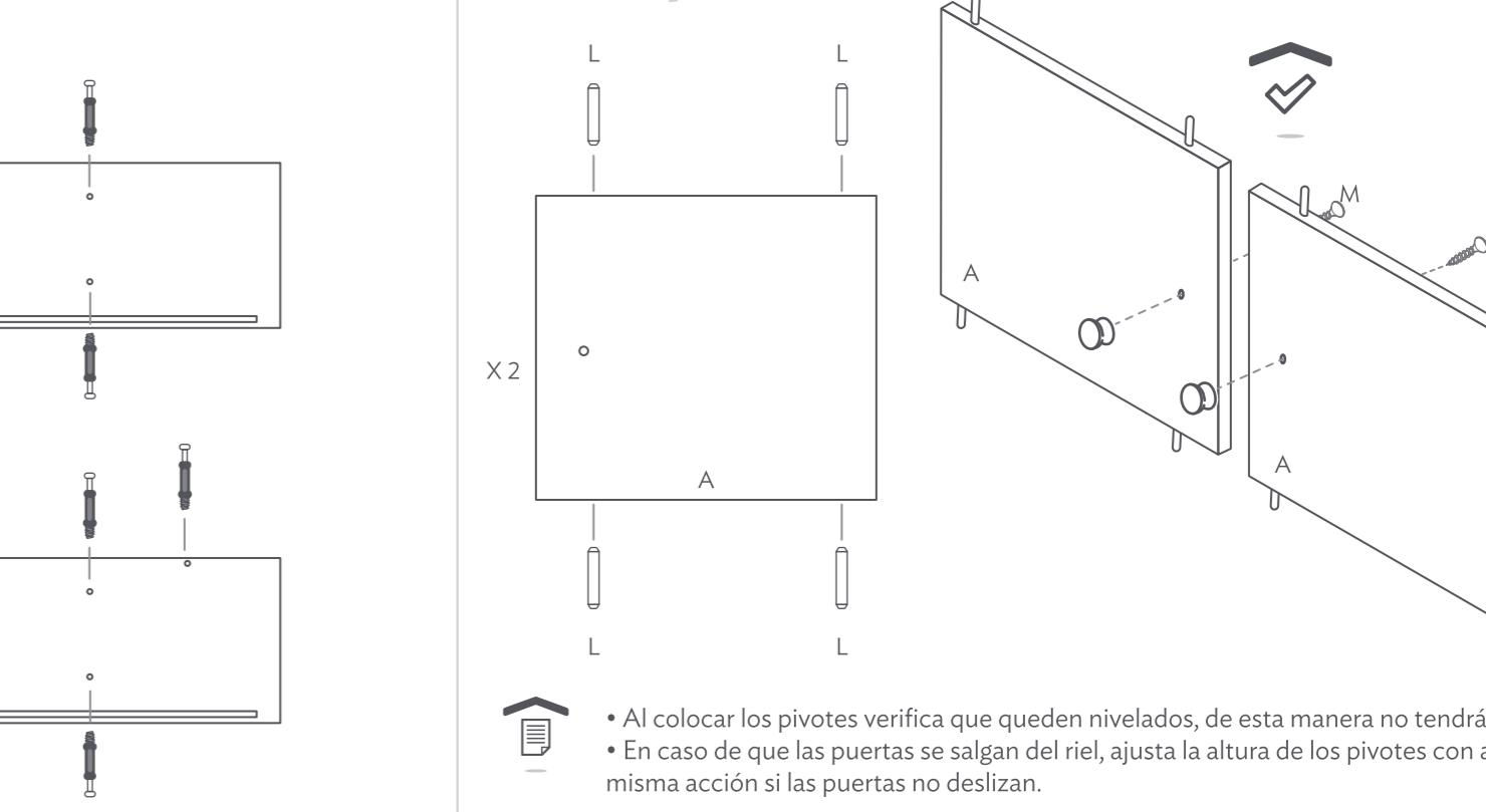
• Al colocar los pivotes verifica que queden nivelados, de esta manera no tendrás problemas deslizando las puertas.
