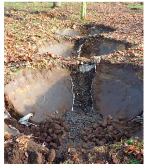
Abb.7: Blick in den Untergrund nach der Entnahme der Bäume. Deutlich ist die Anlage der Wurzelgräben zu erkennen. Zur Dokumentation des Wurzelwachstums wurden die Füllmaterialien ausgeräumt.
