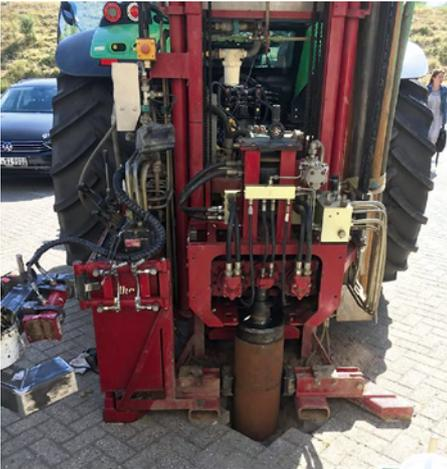
Abb. 6: Erstellung einer Test-MFB auf einer befestigten Oberfläche
