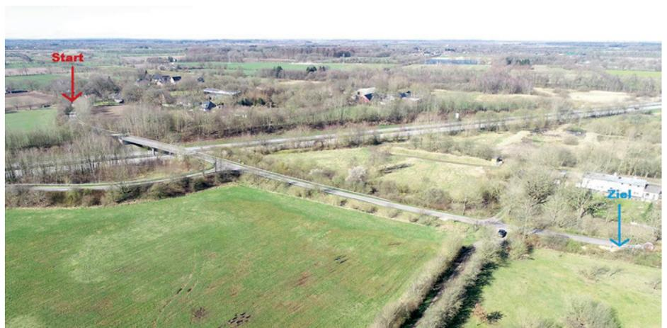
Verlauf der Bohrtrasse (Start: roter Pfeil, Ziel: blauer Pfeil) von West nach Ost mit Unterquerung der vierspurigen Autobahn A7, die in N-S-Richtung verläuft.
