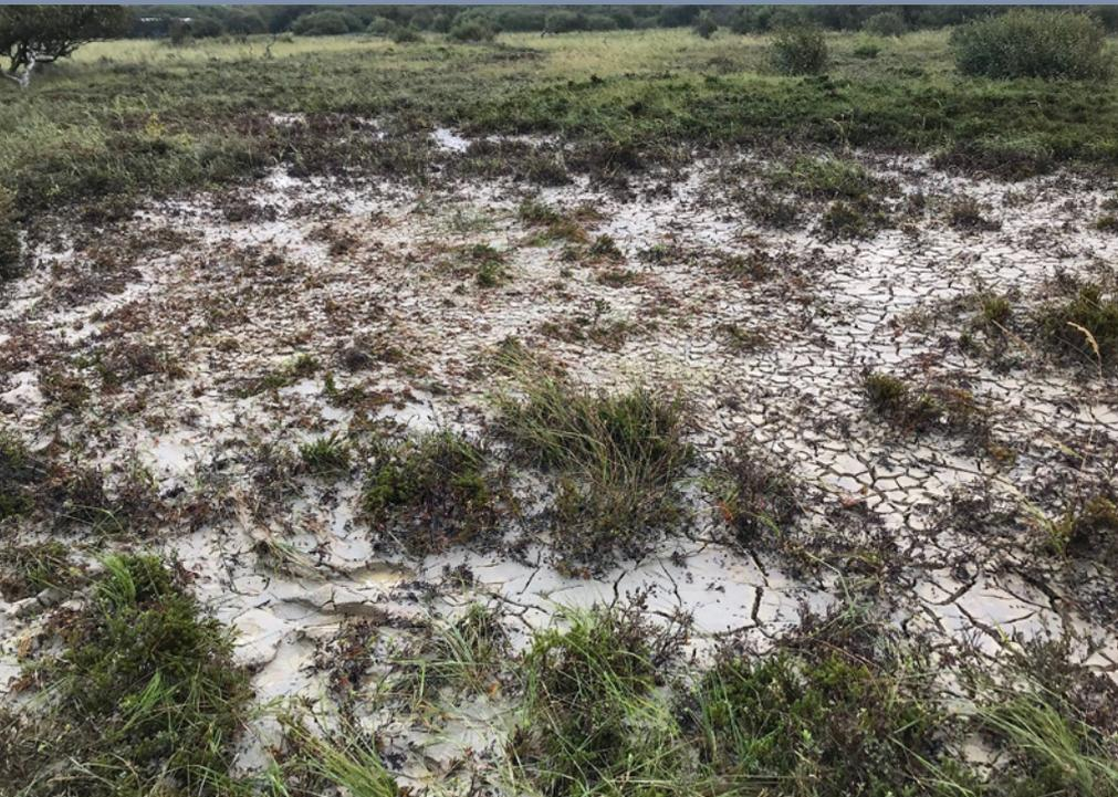
Abb. 1: Spülnungsausbruch in kiesig-sandigem Baugrund
