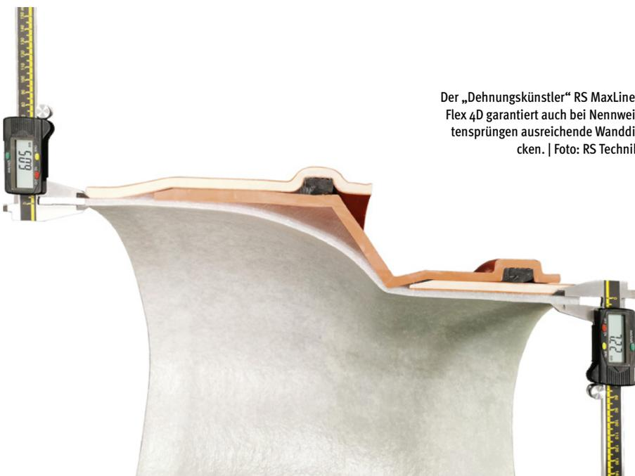
Der „Dehnungskünstler“ RS MaxLiner Flex 4D garantiert auch bei Nennweitesprünge ausreichende Wanddicken. | Foto: RS Technik
