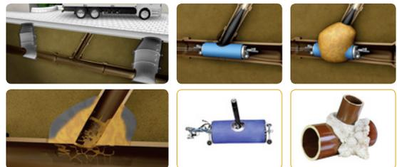
**Technische Daten:** Sammelleitung: DN 185 – DN 700 • Hausanschlußleitung: DN 85 – DN 250 • Leitungsmaterial: Steinzeug, Beton, PVC, Gusseisen
