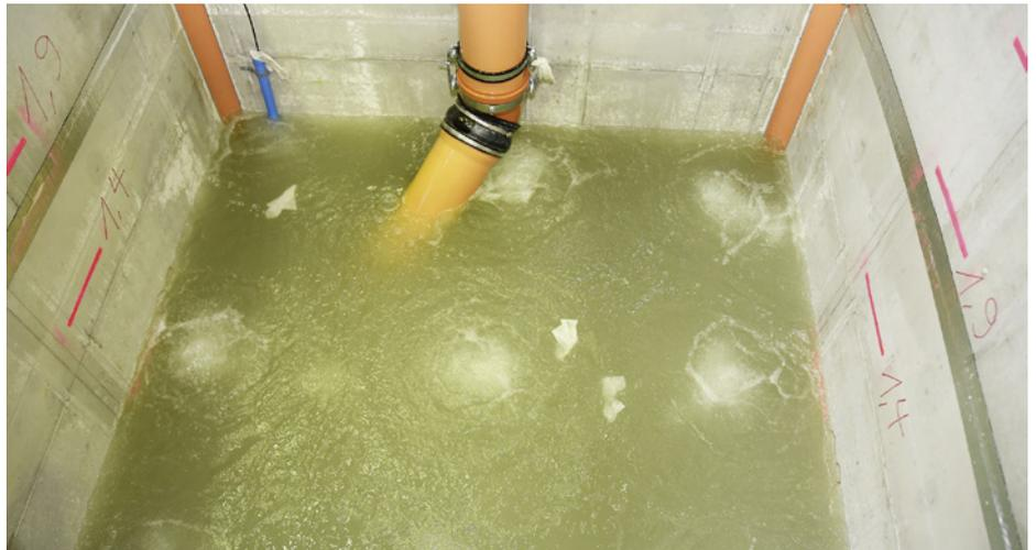
Schmutzwasser mit Tüchern oder anderen Störkörpern kann Drosseln arg zusetzen. Darauf sollte man sich im Betrieb einstellen. (Im Bild das künstliche Schmutzwasser beim IKT-Warentest)
