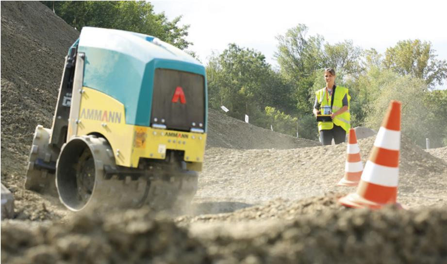
Mit einer Arbeitsbreite von 850 mm ist die ARR 1575 variabel einsetzbar und darüber hinaus mit 640 mm Arbeitsbreite ideal auch für beengte Arbeitsräume geeignet. | Fotos: Ammann Verdichtung
