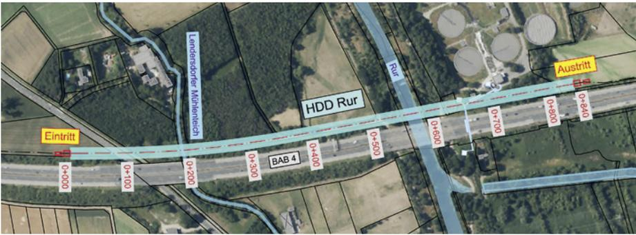
Abb. 8: Lage der C&P-Bohrung „Rur“ an der BAB 4 nahe Düren
