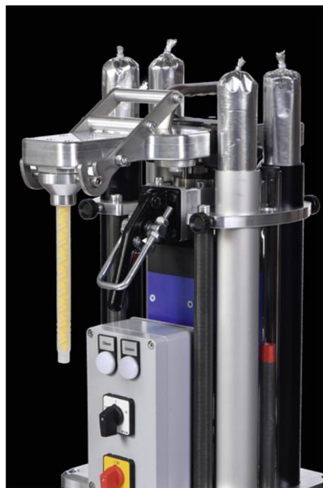
Die Beutel werden am oberen Ende aufgeschnitten und dann in die Auspresseinheit eingeführt. Dort erfolgt die automatische Weiterleitung. Das Gerät ist dabei elektrisch betrieben und dadurch präzise steuerbar, sodass ein wesentlich homogeneres Mischergebnis erzielt werden kann als bei pneumatischen Mixern.
