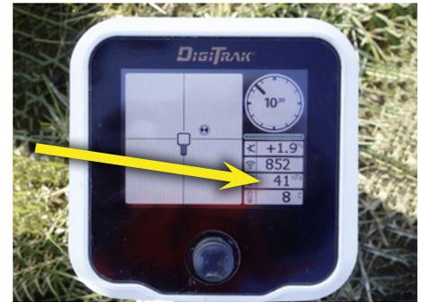
Abb. 5: In ein Walk-Over-System integrierte Messung und Darstellung des Ringraumdrucks
