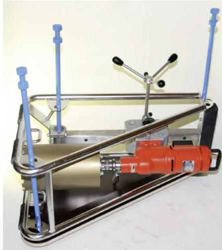
Das DD 300 mit dem Erdbefestigungs-Set aus drei Erdnägeln und Bodenplatte. Mit dem Kanalbohrgerät werden elektrische Kernbohrmaschinen verwindungssteif geführt. | Foto: Diamant Technik Deckers
