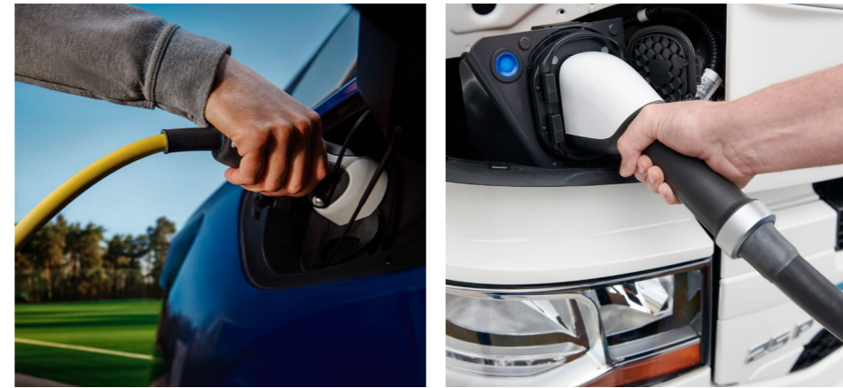
Personbilar och lastbilar har samma "laddhandske" och kan laddas på samma laddstationer.
