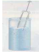
Gambar 10.18 Garputala bergetar yang dicelupkan dalam air (diambil dari Stanley Wolfe, 2003 )
