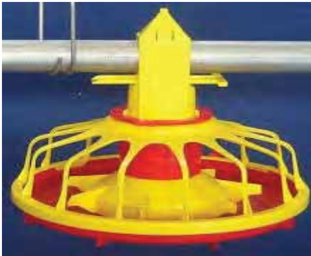
Gambar 24. Tempat pakan bentuk piring (pan feeder)
