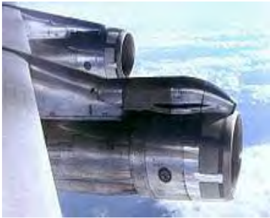
Gbr. 28 Engines nacelles pada sayap pesawat udara
