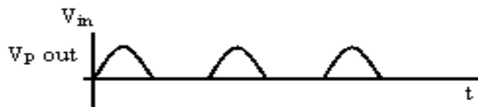
Gambar 2.8. Gelombang Output penyearah Setengah Gelombang Hasil output pada gambar 2.8 sudah berupa arus searah, hanya masih bergelombang, dan munculnya hanya setiap setengah gelombang.
