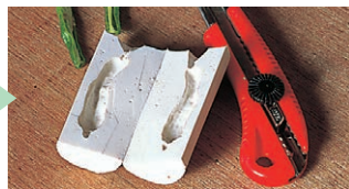
③シリコーンが硬化したら、カッターナイフで二つ割りにカットします。中からししとうを取り出し、ピューターインゴット流しの湯道を作ります。
