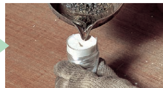
④シリコーンを再び合わせ、シリコーンがインゴットの重さで広がって漏れないように厚ボール紙で巻いて固定します。ピューターを流し込んで、硬化したら完成です。
