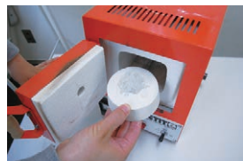
④ガラスカレットを型に詰め、電気炉(約900℃)で焼成し、徐冷する。
