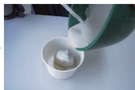
②紙コップに置き、溶いた耐火石膏を流し型を取る。
