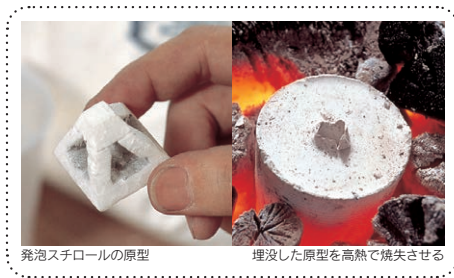
発泡スチロールの原型 埋没した原型を高熱で焼失させる
