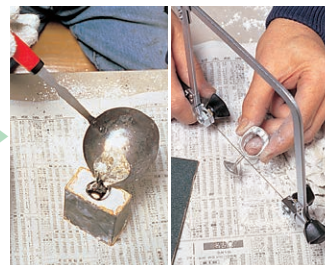
④メタル(ピューター・インゴット)を流し込み、冷えてから割り出して、湯道をカットする。
