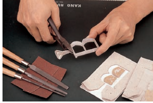
⑦整形する 出来上がったメタルを取り出し、ニッパーで湯道の部分を切り取ります。
