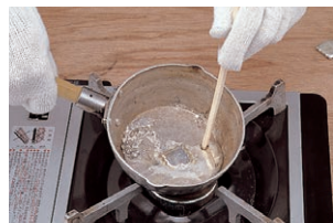
④メタルを溶かす メタルを3~4分間加熱して溶かし、割りばしが薄く焦げるまで待ちます。
