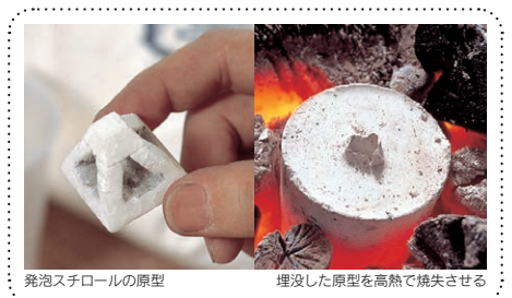
発泡スチロールの原型 埋没した原型を高熱で焼失させる
