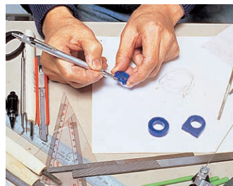
①ワックスを彫刻刀やカッターナイフで削ったり、彫ったりして、指輪の原型をつくる。
