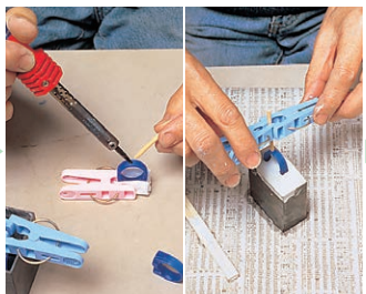
②はんだごてを使って原型に湯道用の丸棒を付け、鑄造金棒に溶いた耐火焼石膏に埋め込む。
