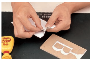
③注ぎ口をつくる 説明図に示してある湯口をつくり、白ボール紙で紙型の両面を糊付けします。
