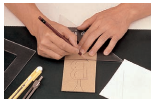
①デザインする 鑄型になるコルクシートに溶けたメタルの流れの道筋を考えて作図する。
