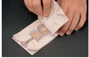
⑥作品を取り出す 紙型を動かさずに5~10分間冷却させ、白ボール紙をはがし取ります。
