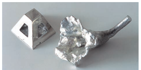
発泡スチロールとワックスによる鑄造例
