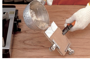
⑤鑄込む 紙型の両面をベニヤ板で強く挟み込み、メタルが冷めないように手早く流し込みます。
