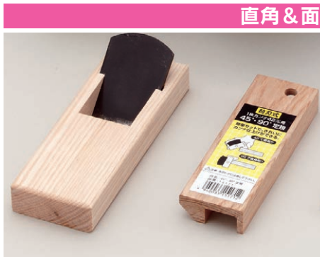
替刃式ミニかな&専用定規 08-0111 替刃式ミニかな&専用定規セット ..... 2,420円 (2,200円) ミニかな: 刃幅42mm・台長150mm・刃出し調整板付 定規: 45°・90°兼用 狭い個所のかんながけに適した小振りのかなです。慣れないと難しい刃出し調整が、専用調整板で誰でも簡単にできる画期的な替刃式かなです(実用新案取得済)。専用定規はかな台にはめるだけで90°の直角削りと45°の面取りができます。 08-0112 替刃式ミニかな 替刃 ..... 880円 (800円)
