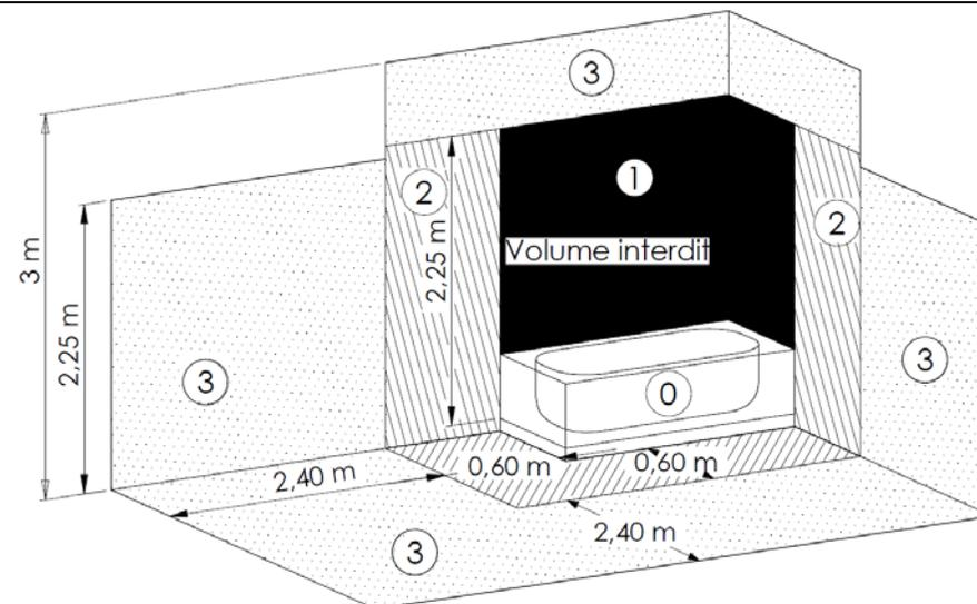
Appareil de classe II IP44, peut être positionné dans le volume 2 de la salle de bain selon la norme NF C126100/A2 :
