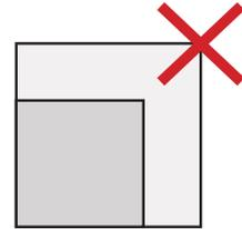
Ne coupez jamais à angle droit ! Utilisez une scie cloche ou une perceuse (Ø10 mini) pour créer un rayon. / Never cut with a right angle! Use a hole saw or a drill (Ø10 mini) to create a radius.
