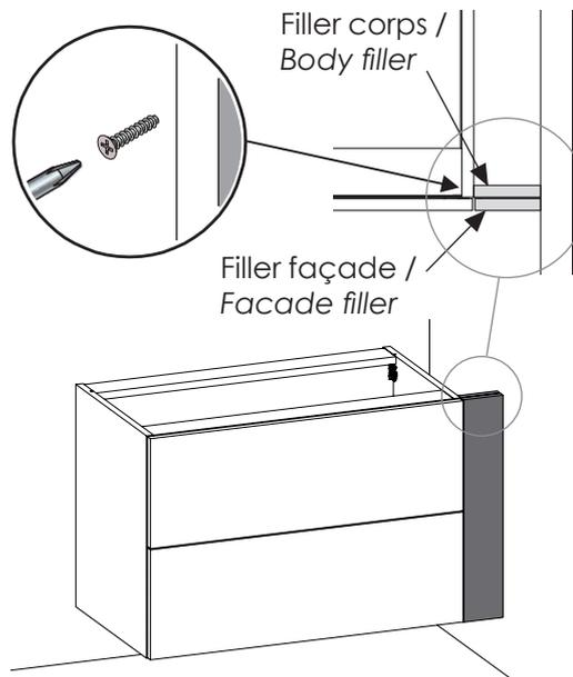
Placez le filler de corps **1 mm en retrait** de l'avant du corps de meuble / Place the body filler **1 mm set back** from the front of the carcass
