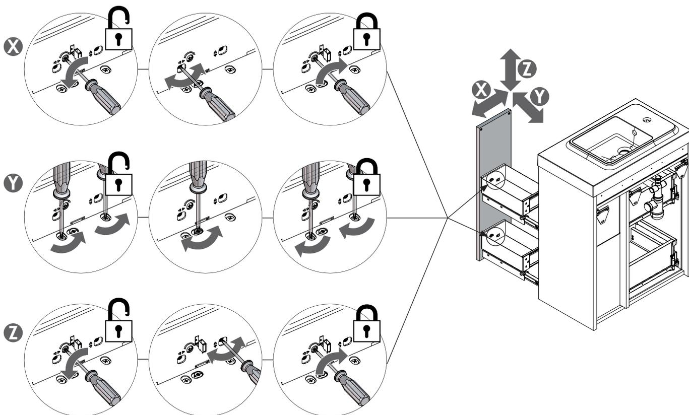
Si besoin : Remontage des façades / If necessary : Reassembly of the doors
