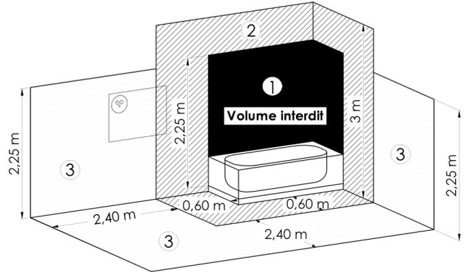
**VOLUME 3 :** Installer des produits de Classe 1 protégés contre les chutes d'eau verticales (IP21), avec prise de courant munie d'une borne terre.
