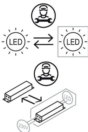
La source lumineuse et l'alimentateur de ce luminaire sont remplaçables par un professionnel. / The light source and the driver of this light is replaceable by a professional.
