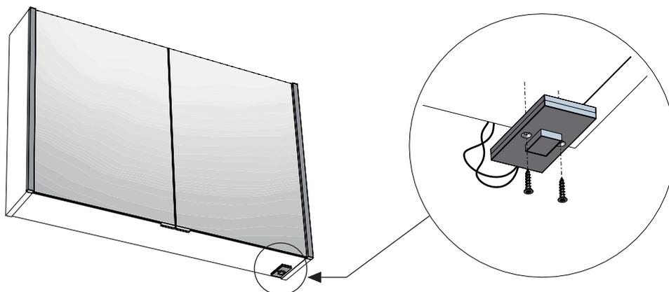
**i** Positionner le capteur au fond du meuble, sur un des côtés. Risque de déclenchements intempestifs si placé au centre du meuble / Place the sensor at the bottom of the cabinet, on one side. Risk of nuisance tripping if placed in the center of the cabinet
