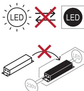
La source lumineuse et l'alimentateur de ce luminaire ne sont pas remplaçables. Lorsque la source lumineuse ou l'alimentateur atteint sa fin de vie, le luminaire entier doit être remplacé. / The light source and the driver of this light are not replaceable. When the light source or the driver reaches the end of its life, the entire light must be replaced.
