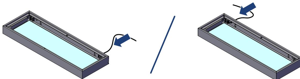
Choisissez le côté du raccordement en fonction de l'emplacement de votre prise électrique / Choose the connection side according to the location of your electrical outlet
