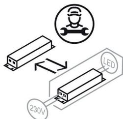
L'alimentateur de ce luminaire est remplaçable par un professionnel. / The driver of this light is replaceable by a professional.
