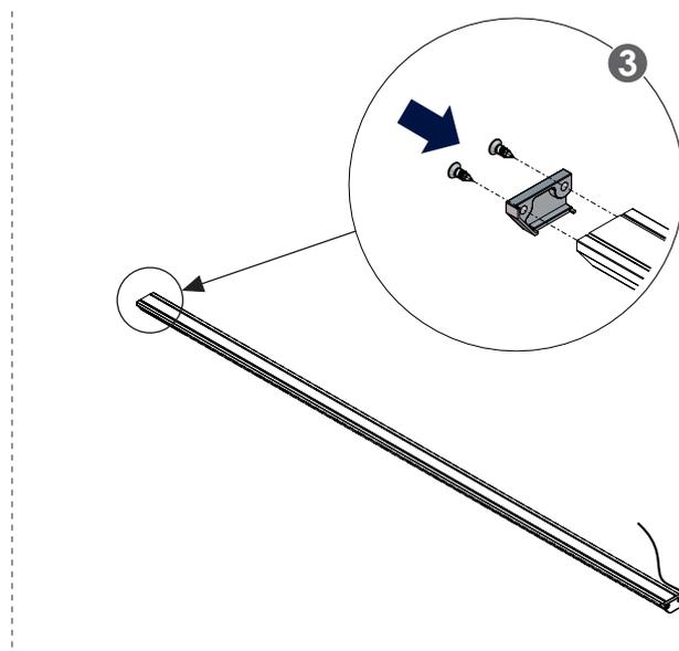
**i** Il restera une zone d'ombre allant de 0 à 40 mm selon la zone de découpe. / It will remain a shadow area ranging from 0 to 40 mm depending on the cutting area.
