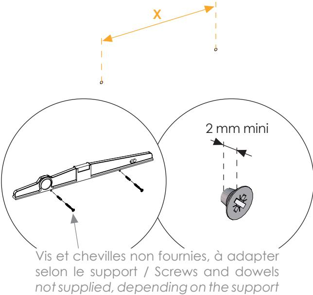
Mesurez les dimensions **X** et **Y** pour positionner les vis et chevilles à la bonne distance. / Measure the **X** and **Y** dimensions to position the screws and dowels at the right distance.
