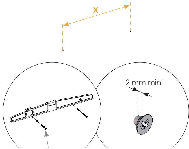
Mesurez les dimensions **X** et **Y** pour positionner les vis et chevilles à la bonne distance. / Measure the **X** and **Y** dimensions to position the screws and dowels at the right distance.
