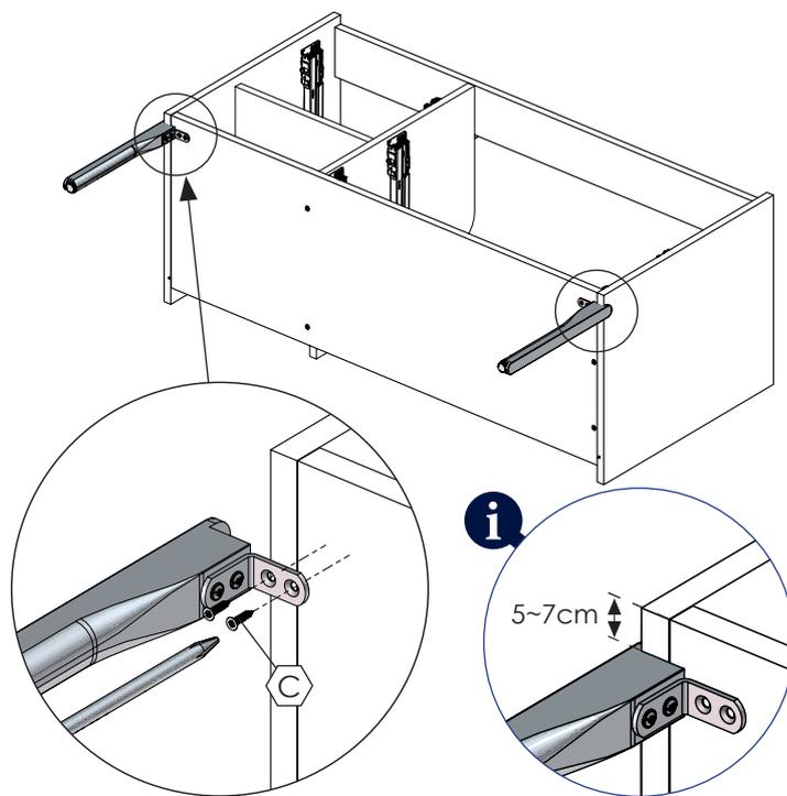
3 Réglage de la hauteur / Height adjustment
