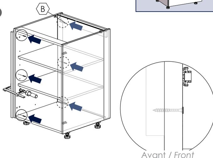
**i** Nombre de vis à adapter selon les dimensions du panneau. / *Number of screws to be adapted according to panel dimensions.*
