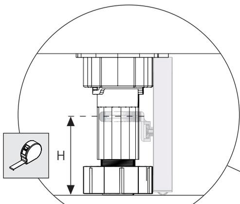
Mesurez la hauteur souhaitée du clip / Measure the desired height of the clip
