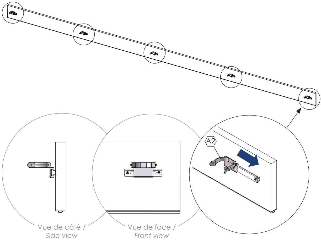
5 Assemblage du socle sur les pieds / Assembly of the plinth on the legs
