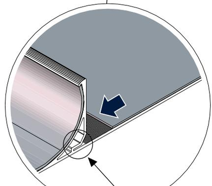
Glissez le tapis dans l'encoche pour le maintenir en place / Slide the mat into the notch to hold it in place
