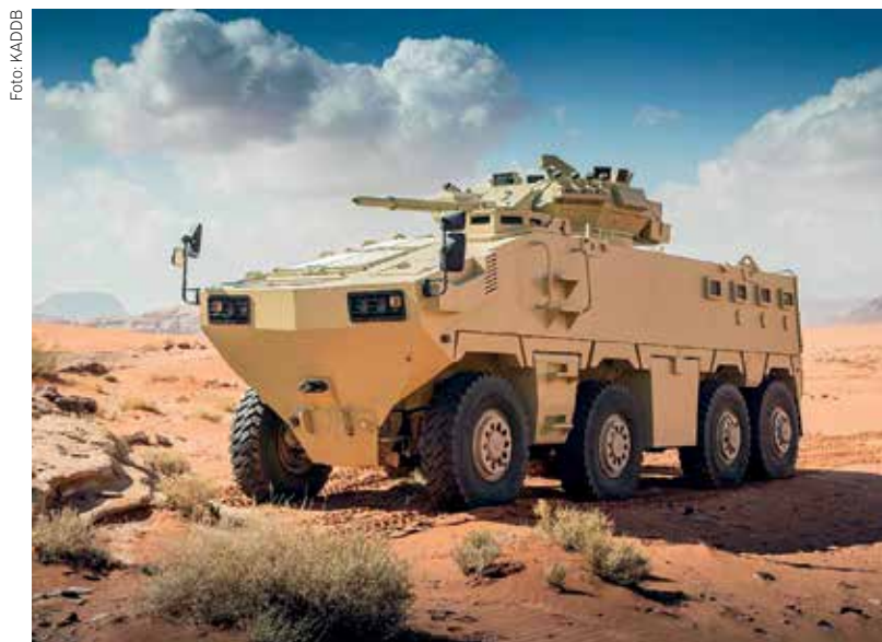
Obrněný transportér typu Al-Mared využívá osmikolový podvozek od společnosti Tatra.
