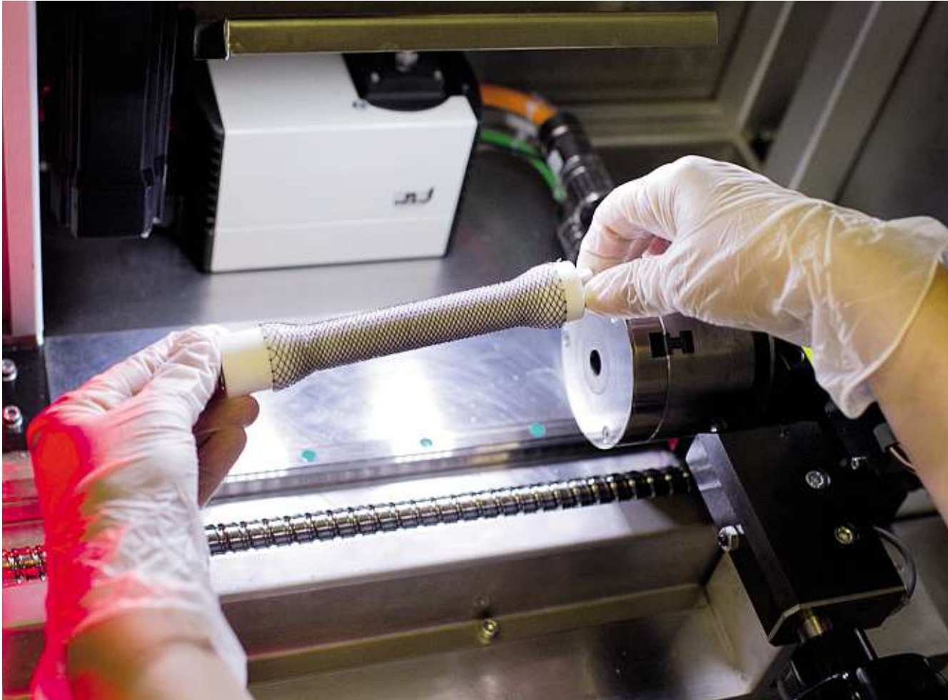
Firma ELLA-CS, jejíž roční tržby činí kolem 120 milionů korun, se nyní specializuje na stenty používané hlavně v gastrointestinálním traktu, tedy trávicí soustavě. Světovou novinkou jsou biodegradabilní výztuže, které se v těle rozpadají. FOTO: PROFIMEDIA
