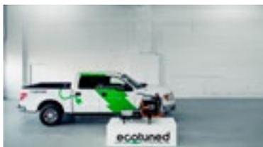
Ecotuned Automobile a développé le premier kit de conversion universel et réutilisable conçu pour transformer des camions légers polluants en véhicules électriques. En mettant à profit la durée de vie d'un million de km du moteur électrique et en tirant
