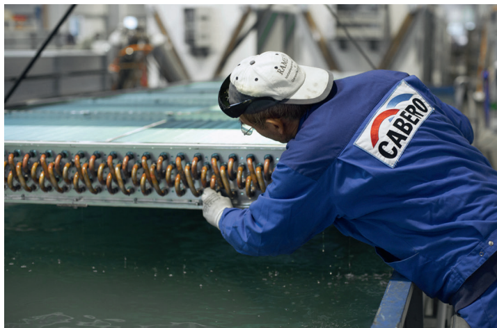
Tanque de pruebas para control final
