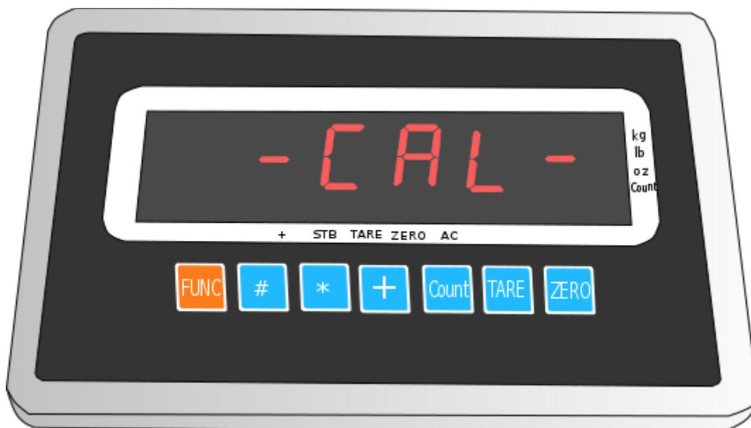
En este punto debemos introducir el peso que vamos a colocar en la báscula, de esa manera la báscula tendrá una referencia de peso.
