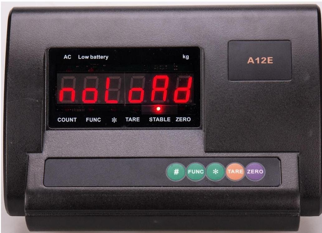
Neste caso, NÃO COLOQUE o peso na balança. Com a balança sem peso e o LED STABLE aceso, confirme com “#” e pule para a próxima etapa:
