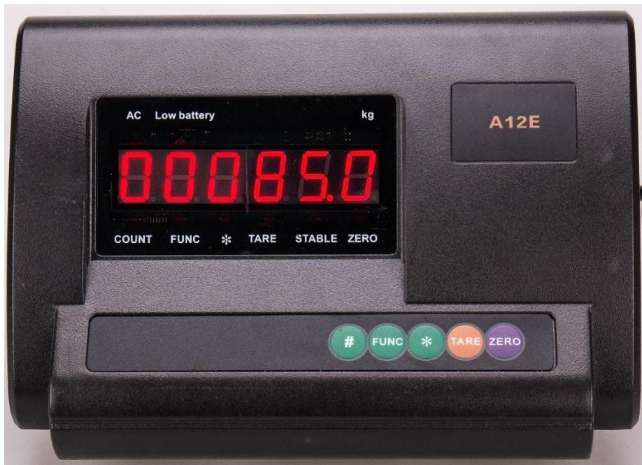
Une fois le poids sélectionné, nous confirmons avec "#". L'écran suivant va apparaître:
