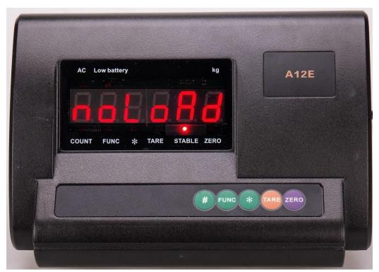
Dans ce cas, il nous demande de NE PAS PLACER de poids sur la balance. Avec la balance sans poids et la LED STABLE allumée, confirmez avec «#» et passez à l'écran suivant:
