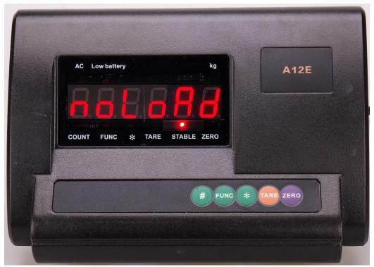
Neste caso, NÃO COLOQUE o peso na balança. Com a balança sem peso e o LED STABLE aceso, confirme com "#" e pule para a próxima etapa:
