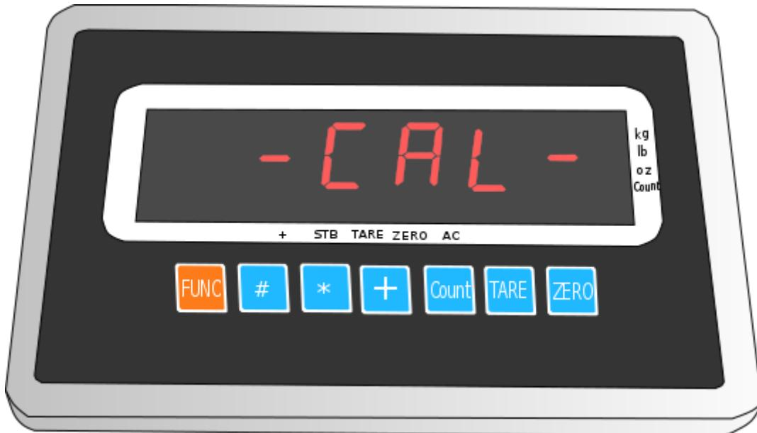
Neste ponto, devemos inserir o peso que vamos colocar na balança, assim a balança terá uma referência de peso.
