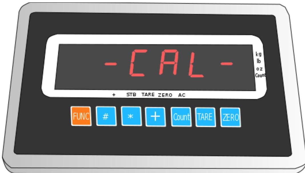
En este punto debemos introducir el peso que vamos a colocar en la báscula, de esa manera la bascula tendrá una referencia de peso.
