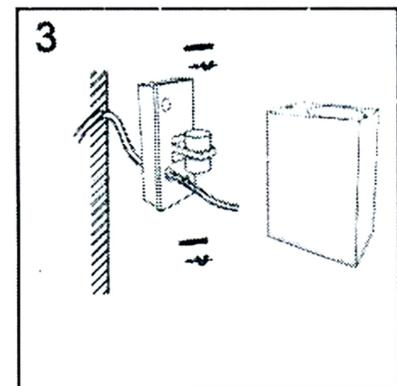
Colocar la base del aplique con los tornillos y hacer el conexionado eléctrico.
