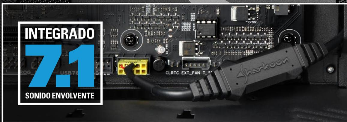
La versión de caja M25-W viene con una tarjeta de sonido envolvente integrada como rasgo característico, y se conecta fácilmente a la placa base vía USB.
