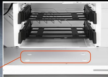
La fuente de alimentación y hasta tres discos duros 3,5" se pueden separar en la parte inferior de la caja, dentro del túnel, evitando así alterar su apariencia.
